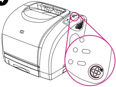
Если заменяемый картридж находится в недоступной позиции, закройте верхнюю крышку и нажмите **ПОВЕРНУТЬ ПОВОРОТНОЕ ЗАГРУЗОЧНОЕ УСТРОЙСТВО**. Повторяйте эту операцию, пока картридж не достигнет нужного положения.
