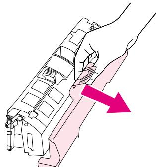
Снимите оранжевую крышку с картриджа. **Внимание:** Прикосновение к ролику может отрицательно повлиять на качество печати.
