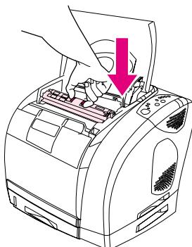
Удерживая картридж за синие фиксаторы, опустите его прямо в поворотное загрузочное устройство, пока он плотно не встанет на место.
