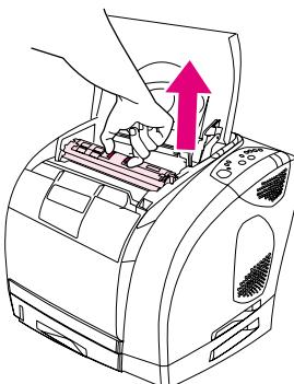
Сожмите синие фиксаторы и извлеките использованный картридж из принтера.
